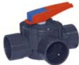
Válvula distribuidora a 3 vías en PVC-U con compuerta rotatoria para el cierre de una vía de paso. Se puede usar en circuitos donde la presión de trabajo no sea superior a 6 bares (90 psi); incluye maneta indicadora del cierre de la vía.
