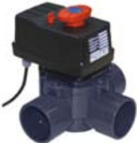
Válvula distribuidora a 3 vías en PVC-U con compuerta rotatoria para el cierre de una vía de paso. Se puede usar en circuitos donde la presión de trabajo no sea superior a 6 bares (90 psi); incluye maneta indicadora del cierre de la vía.
