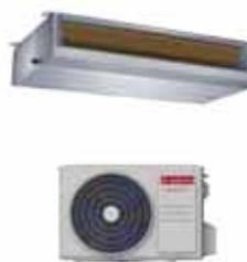
Aire Acondicionado tipo mono-conducto con tecnología 3D INVERTER. Gas refrigerante R32. Tratamiento GOLDEN FIN de la unidad exterior. Funciones Memory, Booster y sensor de pérdidas de refrigerante. Presión estática disponible hasta 160 Pa (excepto modelo 50 con 100 Pa). Bomba de drenaje de serie incluida en unidad interior. Opción de termostato a pared con cables
