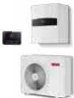
Bomba de calor aire/agua reversible split de alto rendimiento y dimensiones compactas con gas ecológico R32. Unidad interior de instalación en pared con filtro magnético y de partículas, vaso de expansión de 12 litros y resistencias eléctricas de apoyo. Incluye SENSYS NET HD y sonda externa. Tecnología split: con manipulación de gas refrigerante. Conectividad ARISTON NET incluida de serie.
