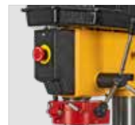
Interruptor de parada de emergencia
