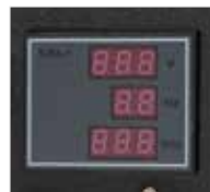
Pantalla (tensión, frecuencia y horómetro)
