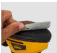
Fijación de las lijas con velcro
