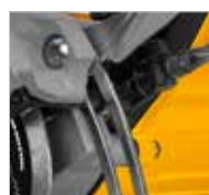
Refrigeración del disco con agua
