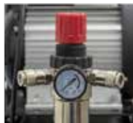
Válvula de salida con regulación de presión
