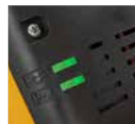
Luces LED indicadoras del estado de las escobillas y de la alimentación eléctrica
