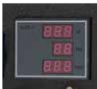
Pantalla (tensión, frecuencia y horómetro)
