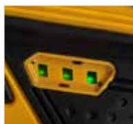
Luces LED del estado de carga de la batería
