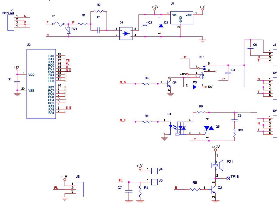
Figura 6: Esquema eléctrico sensor de flujo
