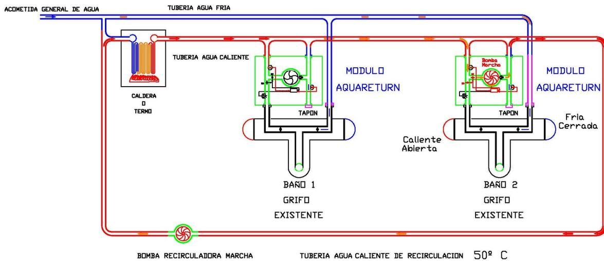
Figura 11: Esquema de funcionamiento con anillo de recirculación en funcionamiento (todos los usos). (Válida en cualquier tipo de instalación con recirculación de ACS, de uso residencial y no residencial, permitiendo ahorro de agua y prevención de la Legionella).
