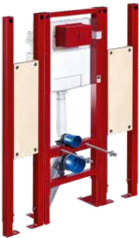
Bastidor de montaje MONTUS (tipo C 120) Altura de montaje 115 cm con cisterna empotrada de 12 cm Accesibilidad para personas de movilidad reducida con dos bastidores para las ayudas técnicas.
