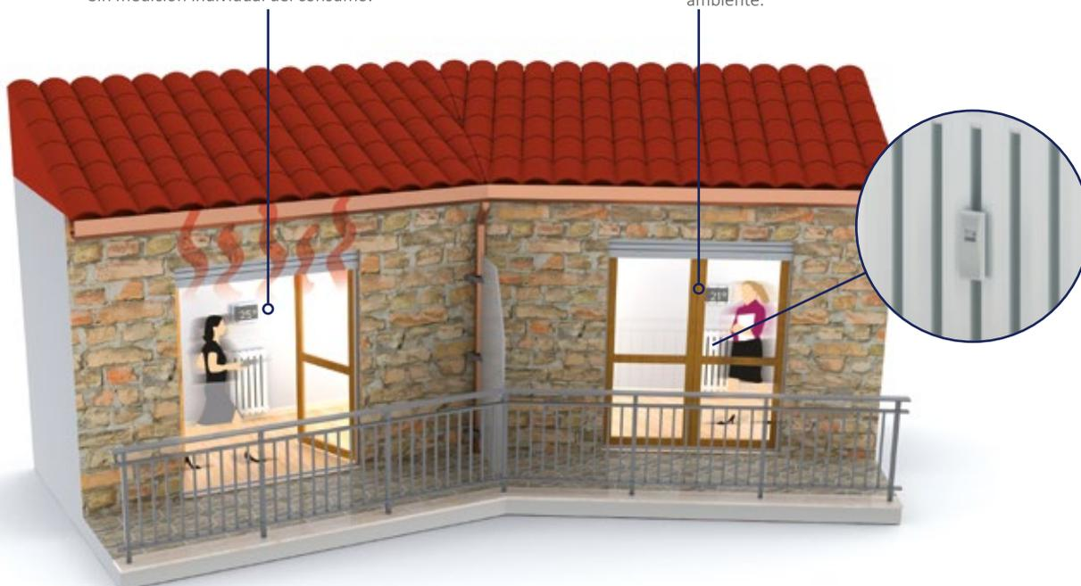
Una instalación de calefacción centralizada, estructurada por columnas verticales, permite regular de manera autónoma la temperatura de cada unidad inmobiliaria: Para cuantificar el consumo y subdividir el coste según el consumo real de cada uno (consumo voluntario), TIEMME propone la instalación de un instrumento específico, el REPARTIDOR.
