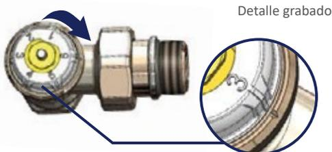
Girar el pomo numerado hasta que el número correspondiente al Kv deseado (véase tabla), esté alineado con el grabado de referencia del cuerpo de la válvula.
