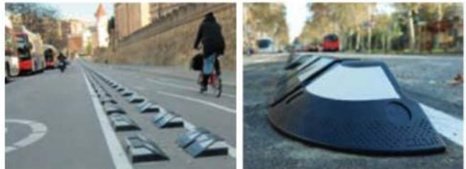
Son elementos diseñados para servir de barrera contra la invasión de vehículos en el carril bici, pero en el caso de que se produzca no suponga un daño importante. Se recomienda la instalación mediante varilla roscada Ø12 mm + resina epoxi.
