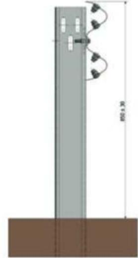
Compuesta por dos vallas de perfil doble onda, separadores estándar y partes CPN 120x55 de 1,7 m cada 1,33 m, tornillería y captafaro cada 8 m.
