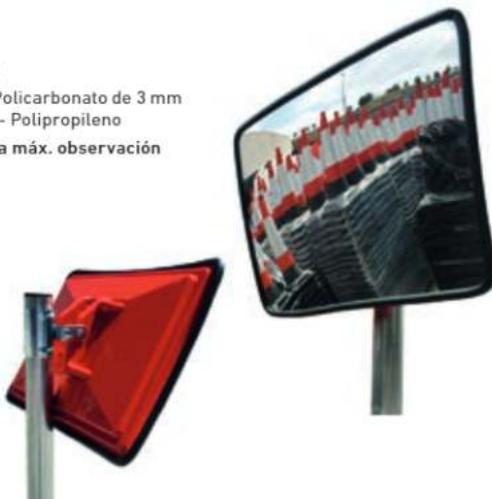
Espejos válidos tanto para el exterior como para el interior. Con visera resistente a la humedad. Al estar fabricada la lente en policarbonato, ésta le da una mayor resistencia ante un posible impacto. Tiene un ángulo de visión de 90°, que se puede ajustar según sus necesidades a través de sus accesorios incluidos, tornillos y anclaje para tubo. El tubo tiene que tener un mínimo de Ø60 mm.
