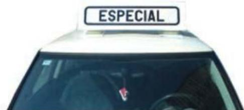
Sirve para indicar la circulación próxima de un vehículo en régimen de transporte especial.
