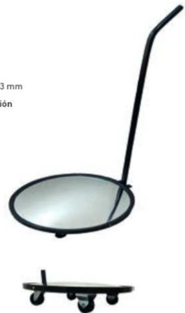
Tiene un ángulo de visión de 90°. Espejo de Ø40 cm y altura desde suelo de 9 cm. Mango plegable de hierro de Ø20 mm y longitud de 83 cm. 4 ruedas de las que 2 son giratorias y con una altura de 5 cm.
