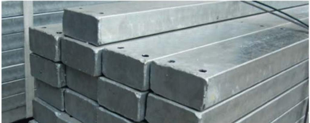
Fabricado en acero galvanizado en caliente, acero de calidad S235JR (UNE EN 10025-2), conforme a las normas UNE EN 12899-1 y UNE 135314 y acabado por inmersión según UNE EN ISO 1461, con tapa de acero soldada en todo el perímetro. Disponible sólo con las 2 perforaciones superiores y en diferentes medidas, alturas y espesores.
