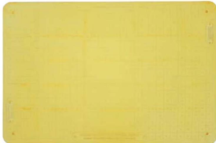
Fabricadas en composite reforzado con fibra de vidrio, con las esquinas redondeadas y la superficie antideslizante. Diseñado para obras de calles. De color amarillo y con resistencia a 2000 kg. de peso bruto del vehículo (500 kg. por rueda). Conforme a la normativa británica "DETR Safety at Streetworks and Roadworks Code of Praticce".
