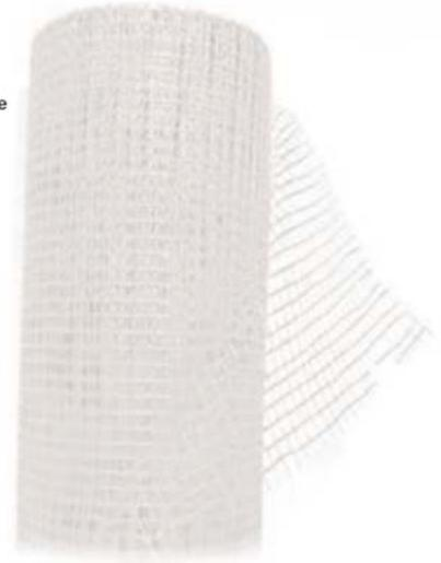
La malla de fibra de vidrio se trata de una armadura tejida de multifilamentos de gran resistencia longitudinal en ambos sentidos. Para ser introducidas entre capas de yeso, escayola, cemento o mortero cuando estas están todavía frescas, aportan una mayor resistencia, evitando el cuarteo y fisuraciones.
