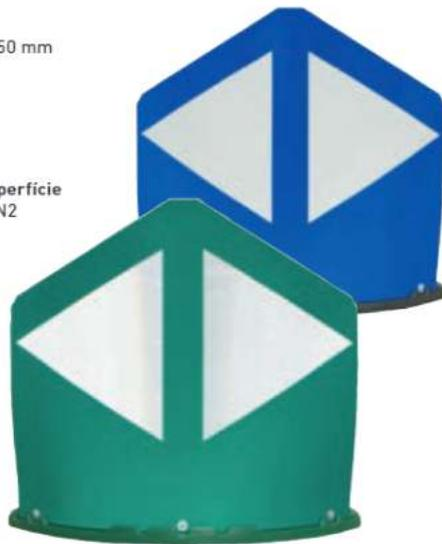
Fabricada en polietileno de alta densidad de una sola pieza. Reflectante tipo H.II. Fabricado en aluminio microprismático. Colores verde y azul disponibles. Se fija al suelo mediante 3 tornillos (incluidos), sencilla y rápidamente.
