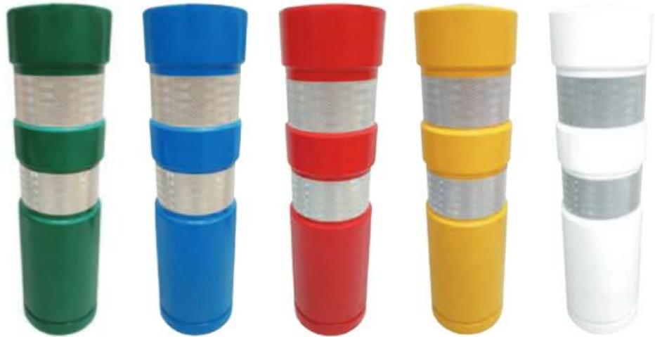
Fabricado conforme con la Norma UNE 135.363. Equipado con 2 bandas Reflex N2 de acuerdo con la Norma UNE 135.334 y con la Norma Europea EN 471. Anclaje interno fabricado en chapa galvanizada de Ø85mm. Incluye tornillería de M12x100mm con su taco estándar. Diseño especial de baliza para proteger su valor de retrorreflectancia de las inclemencias meteorológicas. Fabricado en España.
