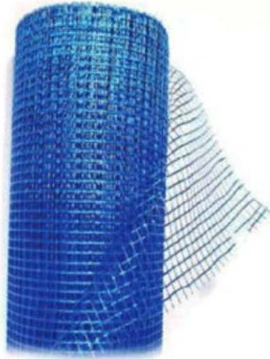
La malla de fibra de vidrio se trata de una armadura tejida de multifilamentos de gran resistencia longitudinal en ambos sentidos. Para ser introducidas entre capas de yeso, escayola, cemento o mortero cuando estas están todavía frescas, aportan una mayor resistencia, evitando el cuarteo y fisuraciones.
