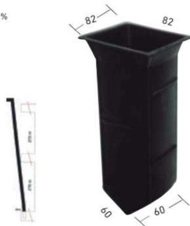
Se utiliza para crear un registro en el forjado que permite la colocación de la horca o pescante que sujetan las redes de seguridad. Su base (de 82x82) se introduce en el forjado y su diseño permite liberar los forjados superiores evitando que la horca se separe excesivamente de los mismos. Es una alternativa a los sistemas tradicionales cuyas horcas excesivamente inclinadas, demasiado separadas o exageradamente rectas, pueden dificultar el montaje de los mismos obligando incluso a perforarlos.
