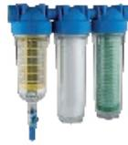
Filtro autolimpiante con grado de filtración de 90 micras, una filtración posterior a 25 micrones y un tratamiento final con carbón activo capaz de eliminar olores y colores que el agua de lluvia asume en el camino hasta tanque de
