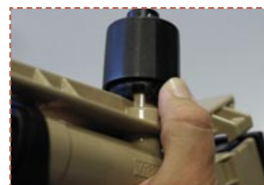
Sencillo ajuste de la tensión del muelle de torsión
