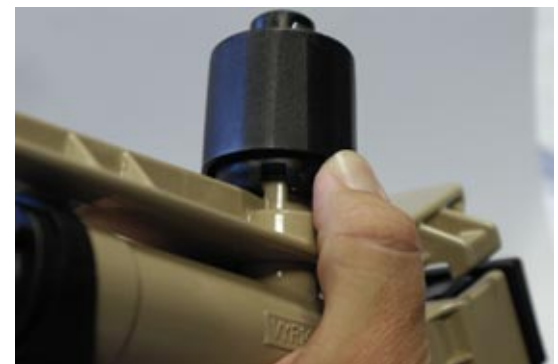
Scillo ajuste de la tensión del muelle de torsión
