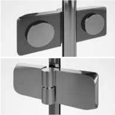
◀ Bisagras regulables de metal cromado, auto-elevable y apertura 180° exterior
