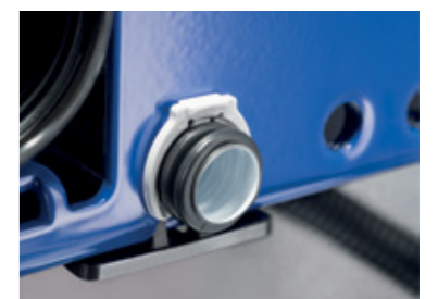
2 Pasar el tubo corrugado por el orificio.
