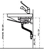
Lavabos en porcelana con frente cóncavo que permite fácil acceso para la silla de ruedas al lavabo y al grifo, con o sin ménsula neumática.
