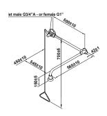
Especialmente diseñado para áreas dónde hay riesgo de salpicaduras de productos químicos peligrosos. Esta ducha de seguridad descontamina inmediatamente al fluir el agua cuando se acciona el tirador de emergencia. El agua fluye hasta que el usuario lo detiene manualmente.
