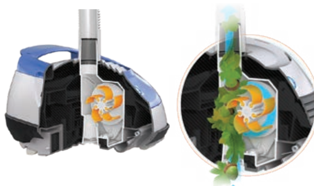
Tecnología patentada V-Flex®: turbina de álabes móviles para capturar los residuos grandes
