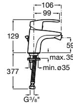
Mezclador monomando exterior baño-ducha con inversor automático.
