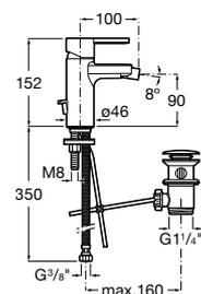
Mezclador monomando exterior baño-ducha con inversor automático.
