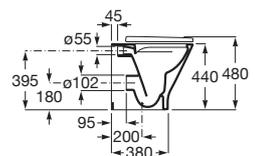
Taza Roca Rimless® con salida dual para inodoro de tanque alto, tanque empotrable o fluxor. Incluye juego de fijación.
