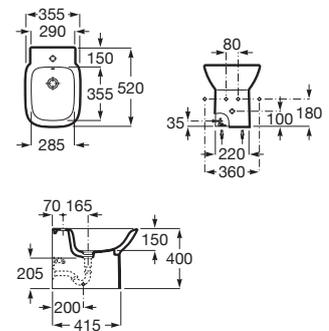
Bidé suspendido. Incluye juego de fijación. No incluye grifería. Para su instalación se requiere un sistema de instalación Roca compatible.
