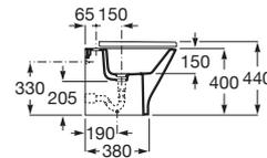
Bidé suspendido con fijaciones ocultas. No incluye grifería. Para su instalación se requiere un sistema de instalación Roca compatible.
