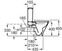
Pack: Inodoro adosado a pared con triturador integrado (oculto), tanque con juego de mecanismos de doble descarga 4,5/3 litros, taza Roca Rimless® y asiento y tapa de Supralit® de caída amortiguada.
