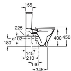
Taza Roca Rimless® compacta con salida dual para inodoro de tanque bajo compacto adosado a pared.
