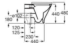
Taza Roca Rimless® para inodoro de tanque alto, tanque empotrable o fluxor.
