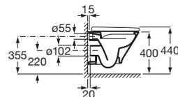
Taza altura Comfort Roca Rimless® para inodoro de tanque alto, tanque empotrable o fluxor.
