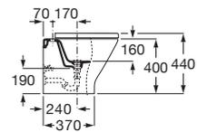
Bidé suspendido sin tapa con fijaciones ocultas. No incluye grifería. Para su instalación se requiere un sistema de instalación Roca compatible.
