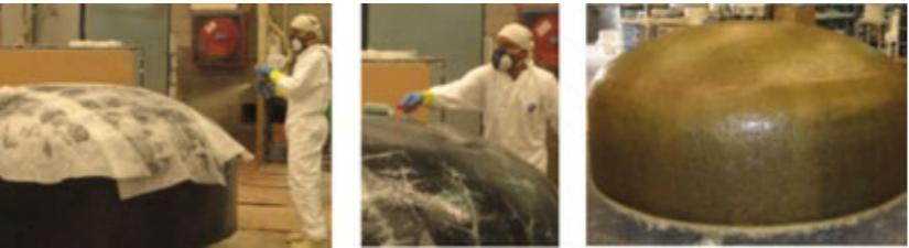
También queremos destacar algunos detalles diferenciales en el proceso de fabricación: los filtros no se pintan. Al realizar el proceso de bobinado, el hilo de fibra de vidrio de poliéster se tinta durante el proceso, esto junto al post-curado en el horno, proporciona un acabado de la superficie del tanque que evita efectos de sudoración una vez instalados.
