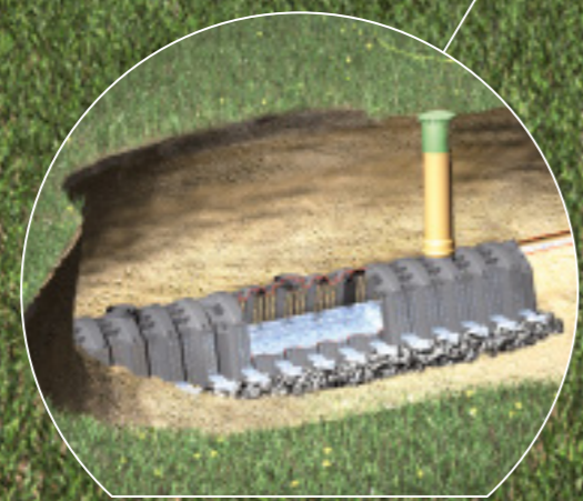
INFILTRACIÓN AGUA DE LLUVIA
