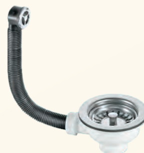
Válvula fregadero. Tapón cestilla acero inoxidable con rebosadero circular. ABS / INOX
