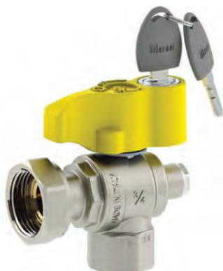
Válvula de esfera en escuadra para gas, conexión Hembra - Tuerca giratoria niquelada, con mariposa de aluminio con cerradura y conexión de presión.
