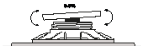
Kit autonivelante para arreglar pendiente entre 0 y 5%
