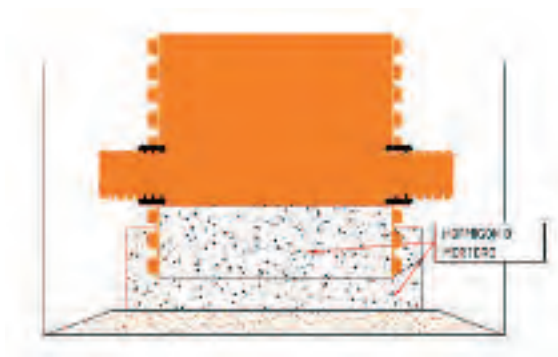
Acabado del fondo del pozo rematado con hormigón (Solamente recomendable sin freático)
