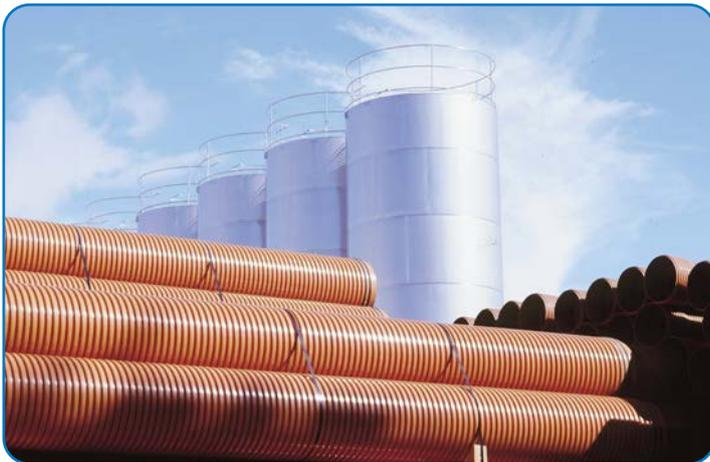
La **tubería SANECOR®** se compone de una **pared estructurada de doble capa, lisa interior y corrugada exterior** en diámetros nominales DN160 - DN1200mm y está diseñada para su uso en redes de alcantarillado urbano, colectores de aguas residuales y, en general, conducciones que transporten soluciones ácidas o alcalinas.
