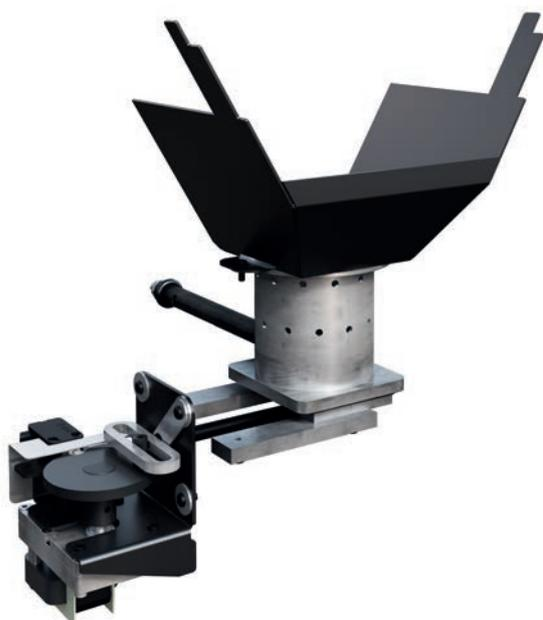
Grazie al movimento meccanico alternativo e traslatorio presente sul fondo del bruciatore tutti i residui della combustione del pellet vengono ri-combusti e quanto rimane viene scaricato all'interno dell'ampio cassetto cenere.
