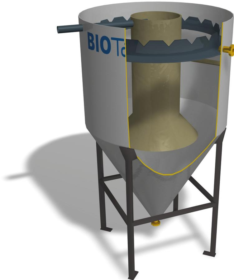
Los decantadores y espesadores de lodos DLT están especialmente diseñados para conseguir un alto nivel de sedimentación de los sólidos en suspensión presentes en el agua residual. La decantación es un método físico por el cual los elementos más densos caen al fondo del decantador por gravedad, mientras que el agua clarificada queda en la parte superior.
