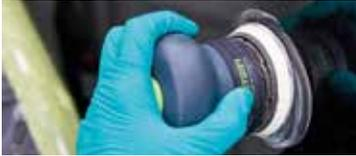
► Reduzca los arañazos con el disco de acabado fino 3M™ Trizact™ 443SA, de grano 6000, 75 mm, en una lijadora orbital.
