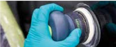
▶ Reduzca los arañazos con el disco de acabado fino 3M™ Trizact™ 443SA, de grano 8000, 75 mm, en una lijadora orbital.
