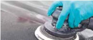
► Lije la zona con el disco de acabado fino 3M™ Trizact™ 443SA, grano 3000, 150 mm, en una lijadora orbital.
