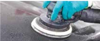
▶ Reduzca los arañazos con el disco de acabado fino 3M™ Trizact™ 443SA, de grano 3000, 150 mm, en una lijadora orbital.
