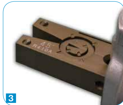
3 Sistema de desconexión rápido de la barra.
