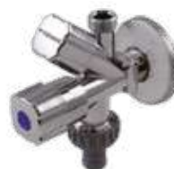
3916C Válvula asiento inclinado combinada con grifo lavadora y lavabo, válvula de retención y embellecedor
