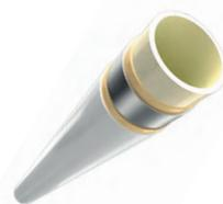
Tubería multicapa especial para **suelo seco**. La capa de aluminio evita la absorción de oxígeno al interior de la instalación y reduce el coeficiente de dilatación.
