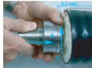
10. Colocar la pieza de conexión (4) sobre el anillo de apoyo, sin la junta. Atornillar el anillo de presión dejando aprox. 0,5 mm de distancia entre la pieza de conexión.
