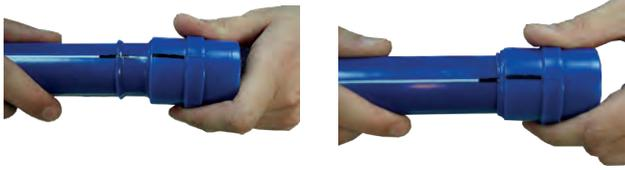
6.-Después del tiempo de calentamiento indicado, extraer rápidamente la tubería y el accesorio de la matriz. Inmediatamente, sin girar, unirlos en línea recta hasta que la marca de profundidad de la soldadura señalada en el tubo sea cubierta por el anillo de polietileno formado en la pieza.
