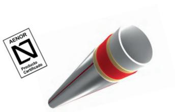
Tubo **POLYTHERM EVOHFLEX PRO** Antidifusión Ø12x1,4 Pert-II. Certificado según norma UNE EN ISO 22.391. Con recubrimiento exterior de polímero con micro partículas metálicas para evitar que la humedad entre en contacto con la capa de evoh lo que:
