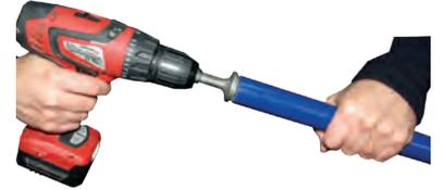
**2b.** Calibrar y matar la arista del tubo para que no dañe las juntas al introducir el accesorio. Para Ø mayores de 32 calibrar siempre con máquina
