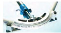
Curvas de raio inferior a 5XD. Além da mola interior devera se usar uma curvadora com matriz exterior, na saída dos tubos do solo á parede com curvas a 90º, utilizar curvas de protecção ou encher bem o espaço posterior á curva do tubo para evitar que ele empurre por dilatação e possa provocar o achatamento do tubo nessa curva
