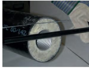
3. Cortar el tubo perpendicular al eje, teniendo cuidado con los cables de detección de fugas.
