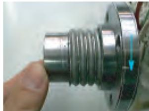
9. Atornillar el anillo de presión (1) a tope. Insertar el anillo de apoyo (2). La rosca tiene que coincidir con el borde del tubo.
