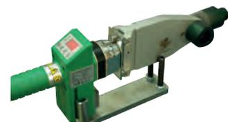
5. Comprobar que los útiles y la máquina para realizar los trabajos de soldadura estén limpios y con la temperatura adecuada (250°C).
