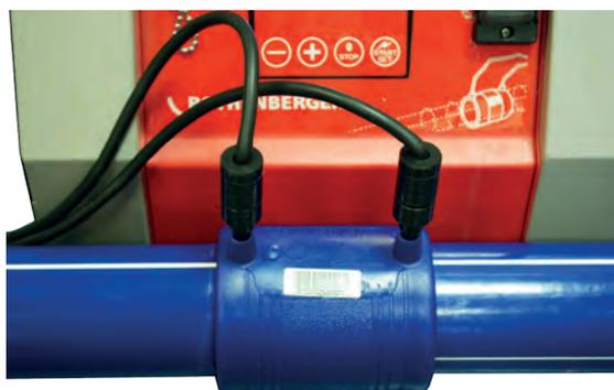
7.- Una vez colocados los tubos en el accesorio, podemos proceder a realizar el proceso de soldadura. Para ello insertar los terminales de los electrodos en los terminales del accesorio.
