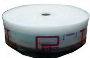
Banda de espuma de polietileno que se instala en forma de rodapié en todos los paramentos verticales para absorber las dilataciones de los pavimentos y eliminar los puentes térmicos con los cerramientos. Incorpora un film de polietileno para evitar la filtración de mortero entre el aislamiento perimetral y aislamiento del suelo.
