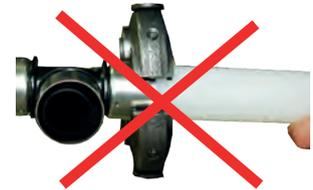
5. Insertar la cuna adecuada al diámetro exterior del tubo que se está conectando. Colocar la boca de la prensa centrada en el casquillo, pegando a la balona. (No prensar nunca fuera del casquillo).
