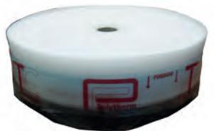
Banda de espuma de polietileno que se instala en forma de rodapié en todos los paramentos verticales para absorber las dilataciones de los pavimentos y eliminar los puentes térmicos con los cerramientos. Incorpora un film de polietileno para evitar la filtración de mortero entre el aislamiento perimetral y aislamiento del suelo.
