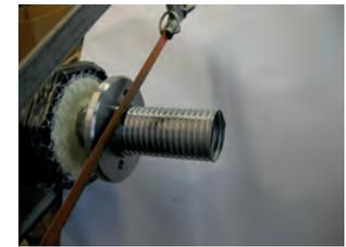
8. Cortar el tubo interior perpendicularmente con ayuda del anillo de presión.
