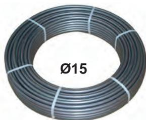
Tubo **POLYTHERM EVOHFLEX PLUS** Antidifusión Ø15x1,5 Pert-II. Certificado según norma UNE EN ISO 22.391. Incorpora recubrimiento exterior de polímero con micro partículas metálicas para evitar que la humedad entre en contacto con la capa de evoh aportando las siguientes ventajas:
