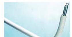
Curva. Raios de curva inferiores a 12 vezes o diâmetro do tubo é necessário a utilização de uma mola no seu interior para evitar o despegamento entre a capa interior e capa de alumínio ou reduzir ou obstruir a passagem da água.
