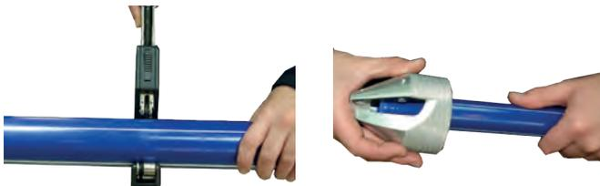
2.- Cortar el tubo perpendicularmente a la generatriz y achaflanar el extremo cortado exterior e interiormente. Antes de soldar el tubo con las piezas, limpiar las zonas de unión (tubo y piezas) con el producto de limpieza para polietileno (PE), y asegurarse que las matrices estén limpias sin ningún resto de material de la soldadura anterior .
