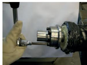
13. Engrasar los tornillos. Colocar la pieza de conexión. Apretar los tornillos hasta que se junten la pieza de conexión y el anillo de presión.
