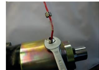
16. Introducir el cable detector de fugas por la tapón protector (5) e instalar.
