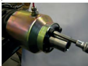
17. Desatornillar dos de los tornillos y colocar con ayuda de las arandelas la chapa contra el anillo de presión.
