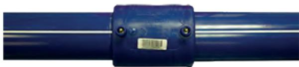
6.- Comprobar que los tubos a soldar estén alineados y libres de tensiones. En el caso de manguitos el tubo introducido no debe sobrepasar la mitad de la longitud del manguito. Si quedase un espacio entre las puntas de los tubos éste debe ser simétrico al centro del manguito.
