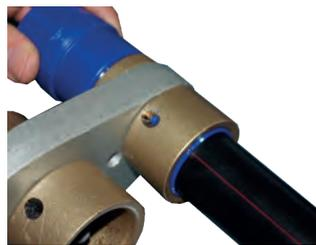
5.- Proceder a la soldadura tal y como se indican en las instrucciones de instalación por termofusión.
