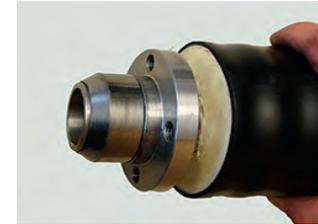
12. El anillo de apoyo tiene que estar visible de 1-2 mm.
