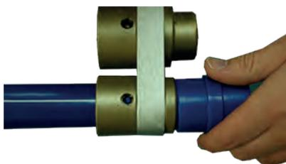
5.- Introducir el extremo de la tubería en la matriz, sin girar, hasta que se vea por el visor o llegue a la línea de profundidad de soldadura marcada. Al mismo tiempo, introducir la pieza, sin girar, hasta el tope de la matriz.
