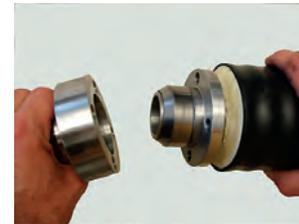
11. Quitar la pieza de conexión y colocar la junta de grafito (3) sobre el anillo de apoyo.
