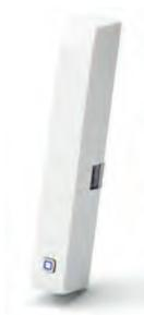
El contacto óptico Polyalpha IP ventana/puerta facilita el cierre automático de las válvulas cuando se abren las ventanas o puertas, p.e. cuando se ventila. El contacto óptico Poly Alpha IP se coloca en la ventana a través de la cinta adhesiva o los tornillos suministrados y detecta a través de un sensor óptico si la ventana o puerta está abierta o cerrada.
