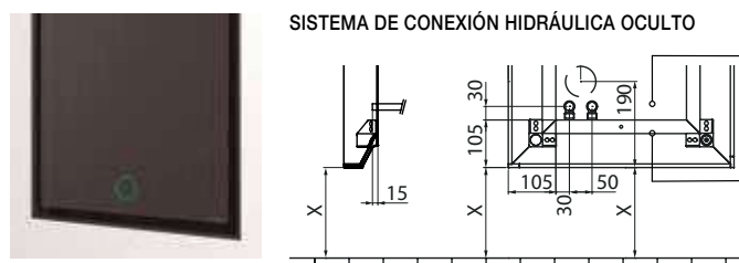
SISTEMA DE CONEXIÓN HIDRÁULICA OCULTO
