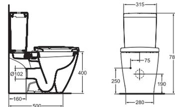
Esquema Aquablade con salida dual
