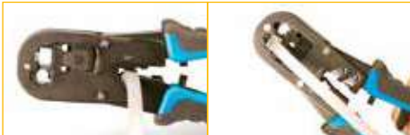
Corte de cables de red
