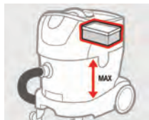
Filtro Plano, utilización completa del depósito
