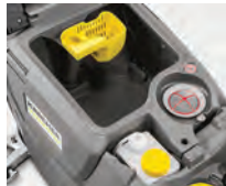
Sistema de dos depósitos
