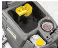
Sistema de dos depósitos
