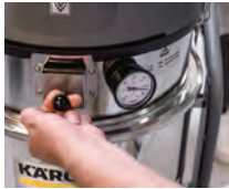
Limpieza de filtro Pull clean
