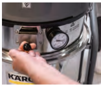
Limpieza de filtro Pull clean
