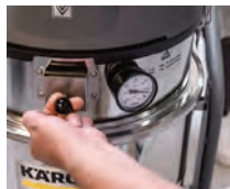
Limpieza de filtro Pull clean
