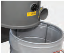
Sistema de vaciado sin polvo con bolsa de PE
