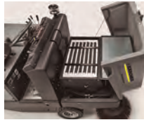
Gran filtro de mangas con limpieza por vibración
