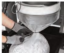
Sistema de descarga en bolsa Longopac
