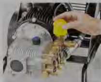
Ajuste de presión y caudal
