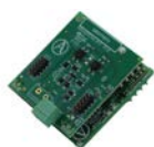
Pasarelas de aerotermia
